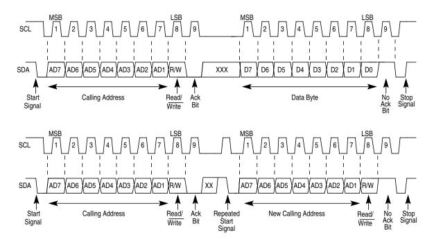
Figure 10-9. IIC-Bus Transmission Signals
